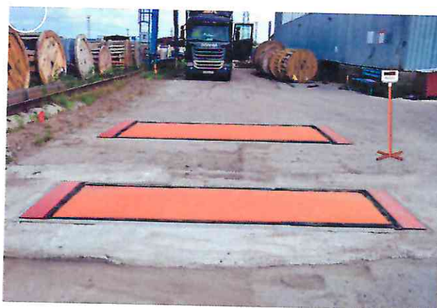
Рисунок 2 - Общий вид модификации весов МВСК П-О
