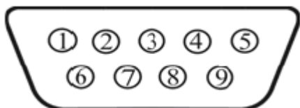
Рисунок А.5–Разъем интерфейса PROFIBUS-DP, клеммный соединитель входит в комплект поставки
