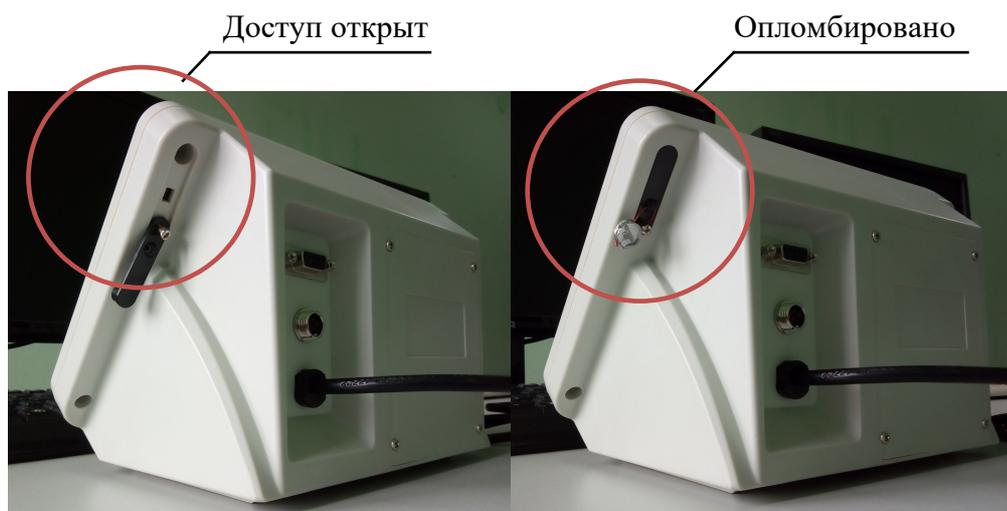
Рисунок 1 – Схема пломбировки от несанкционированного доступа
