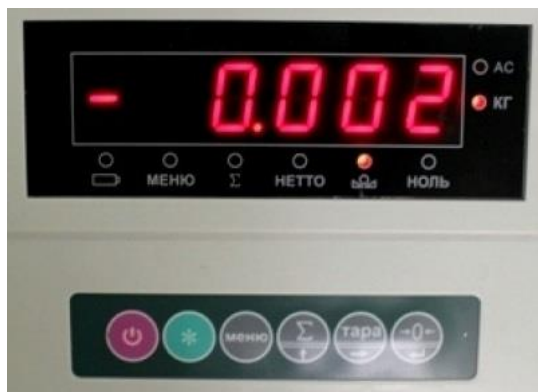
Рисунок 3 – Общий вид передней панели КСК18
