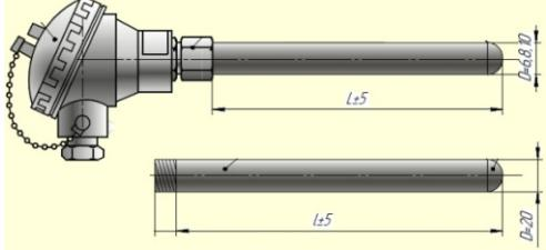
**Датчики температуры ТРИД представлены в обширном ассортименте термопар и термосопротивлений с различными длинами и диаметрами в исполнениях с кабельным выводом и коммутационной головкой.**
