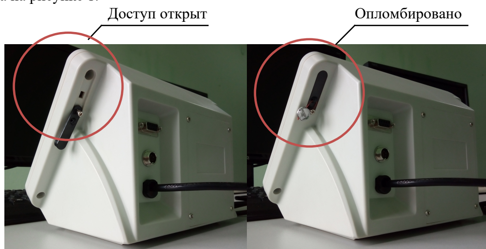
Рисунок 1 – Схема пломбировки от несанкционированного доступа
