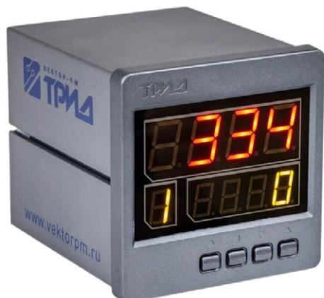
Приборы серии КСК10.1.5-1В5Р1А предназначены для измерения и индикации значений веса и осуществления функции дозирования. Дозирование осуществляется путём программного управления исполнительными устройствами. Исполнительными устройствами в приборах являются электромагнитные реле. Для измерения веса в качестве первичных преобразователей используются тензодатчики.
