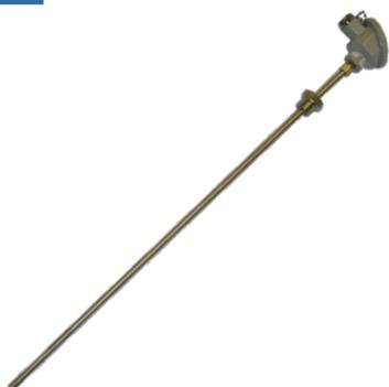
Кабель КТМС изготавливается в оболочке из нержавеющей стали с минеральной изоляцией из оксида магния MgO. Токопроводящая часть представляет собой две однопроволочные жилы, проложенные параллельно. Материалом изготовления жил служит сплав хромеля и алюминия.
