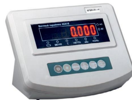
Принцип работы прибора основан на измерении сигнала с подключаемых к нему тензодатчиков и преобразовании его в цифровой код. К прибору должны подключаться полномостовые тензодатчики. Питание тензодатчиков осуществляется посредством встроенного в прибор источника напряжения. Измерение сигнала происходит встроенным в прибор АЦП.
