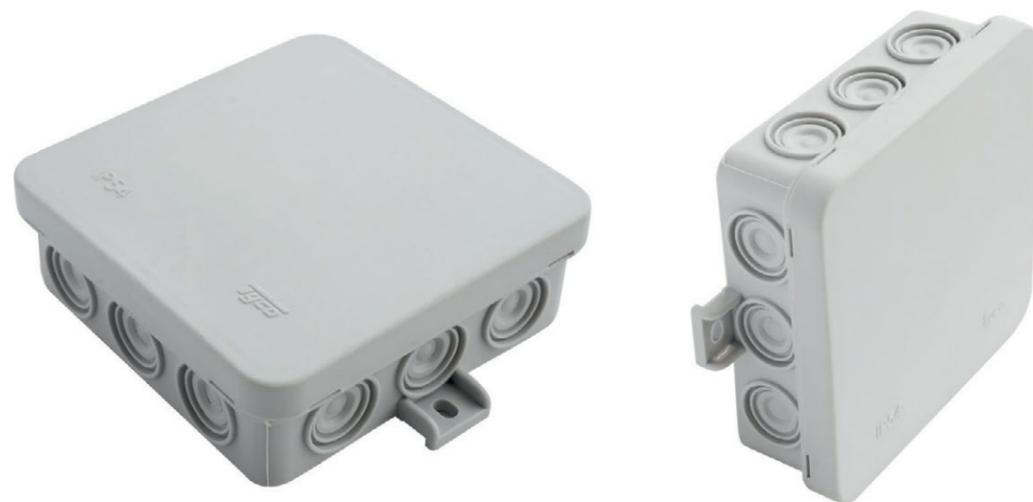
Клеммная коробка предназначена для параллельного подключения нескольких (до 4 шт.) тензометрических датчиков, работающих параллельно в составе весовых систем (весов), а также в составе устройств измерения статических или медленно изменяющихся сил, весовых дозаторов и других весовых систем. Клеммная коробка предназначена для работы в условиях макроклиматических районов с умеренным и холодным климатом и соответствует группе УХЛ2 по ГОСТ 15150.
