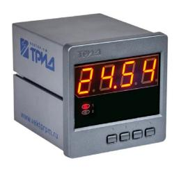
Приборы КСК10.0 предназначены для измерения аналоговых выходных сигналов весоизмерительных датчиков и преобразования их в значение веса. Приборы имеют два выходных реле, которые могут быть использованы для сигнализации, либо для автоматизации дозирования. Для подключения к компьютеру или контроллеру приборы имеют интерфейс RS485. Для работы в сети RS485 приборы используют протокол Modbus-ASCII или Modbus-RTU.
