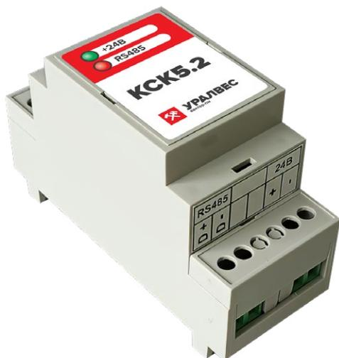
Прибор предназначен для измерения сигналов мостовых тензометрических датчиков, преобразования данных измерений в числовые значения и передачи результатов в сеть RS-485 по одному из поддерживаемых устройством протоколов.
